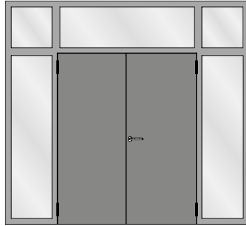
Verblechte zweiflügelige Türe mit zwei Seitenteilen und Oberlichtern Porte tôlée à deux vantaux avec deux parties latérales et impostes Sheet metal double leaf door with two side lights and top lights
