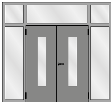
Verblechte zweiflügelige Türe mit zwei festen Seitenteilen und festem Oberlichtern Porte tôle à deux vantaux avec deux parties latérales fixes et impostes fixes Sheet metal double leaf door with two fixed side lights and fixed top lights
