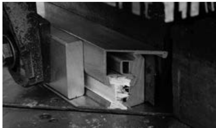
Zuschnitt mit Einspannunterlagen (Flügelprofil) Découpe avec cale de sciage (profilé de vantail) Cutting with anti-pressure support (vent frame section)
