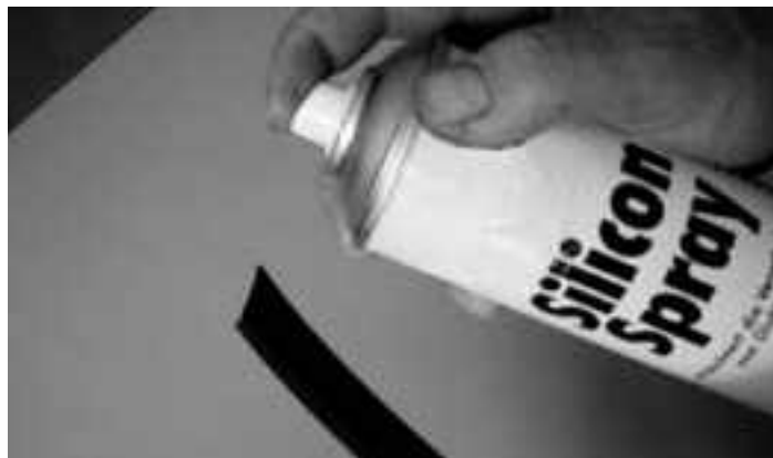
Dichtungen mit Silikon besprühen Vaporiser les joints avec du silicone Spraying the weatherstrips with silicone
